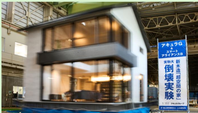
様々な地震波を加振する「実物大耐震実験」の様子 (2021年9月撮影)
